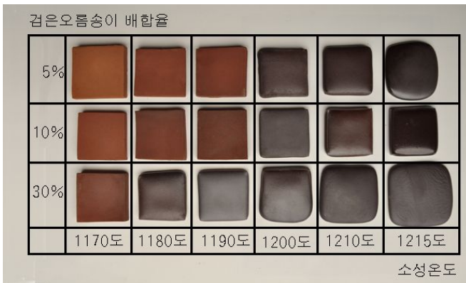
<그림 10>녹는점과 색상실험의 결과(전기가마소성) (수비과정을 거친 조수리 용기토에 검은오염 물이 혼합)
