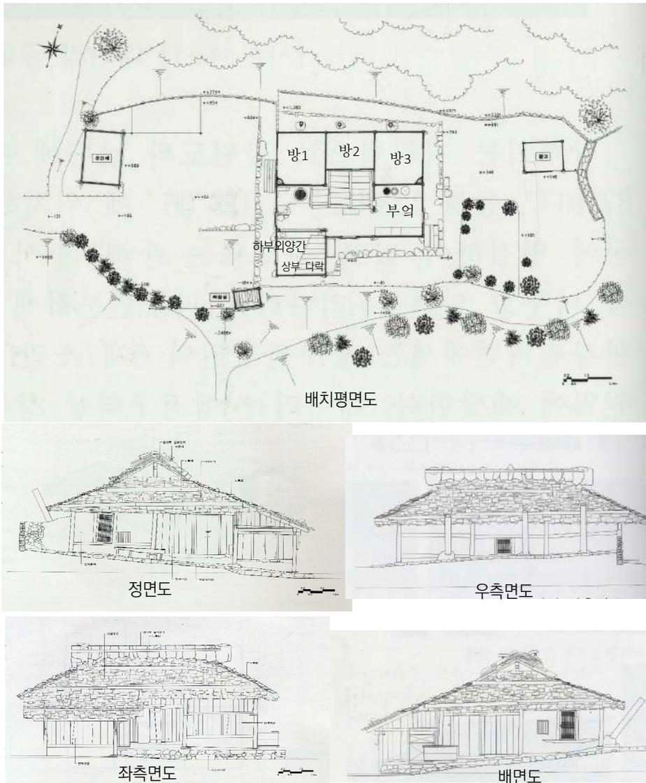
〈그림 20〉 삼척 대이리 너와집 배치평면도 및 측면도
