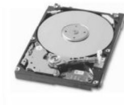
1 하드디스크의 내부 모습. 플러터(자기디스크)를 확인시켜 데이터를 저장하거나 기록한다
