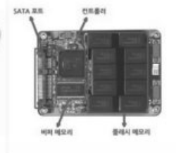
1 SATA 방식 인터페이스와 플래시 메모리를 갖춘 일반적인 SSD의 내부 구조
