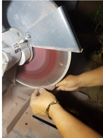
【그림 12】 고속절단기를 이용한 현무암 재단 및 절단
