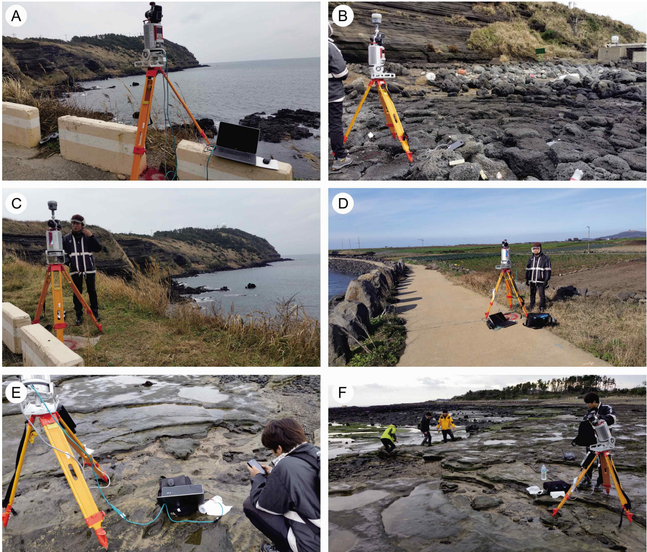
그림 3-53. 지상 라이다 측량 전경. A & B: 수월봉 해안, C & D: 송악산 해안, E & F: 발자국 화석산지.
