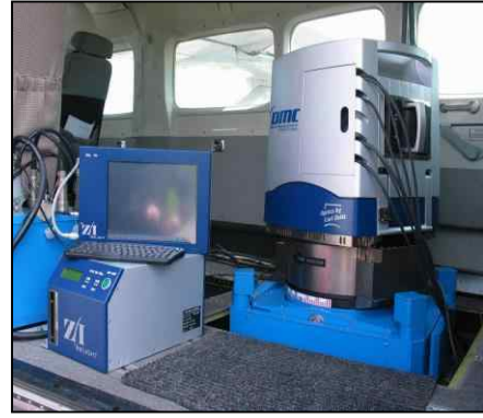
그림 3-34. 디지털 항공사진 촬영방법. 그림 3-35. 디지털 항공사진 촬영장비(DMC).
