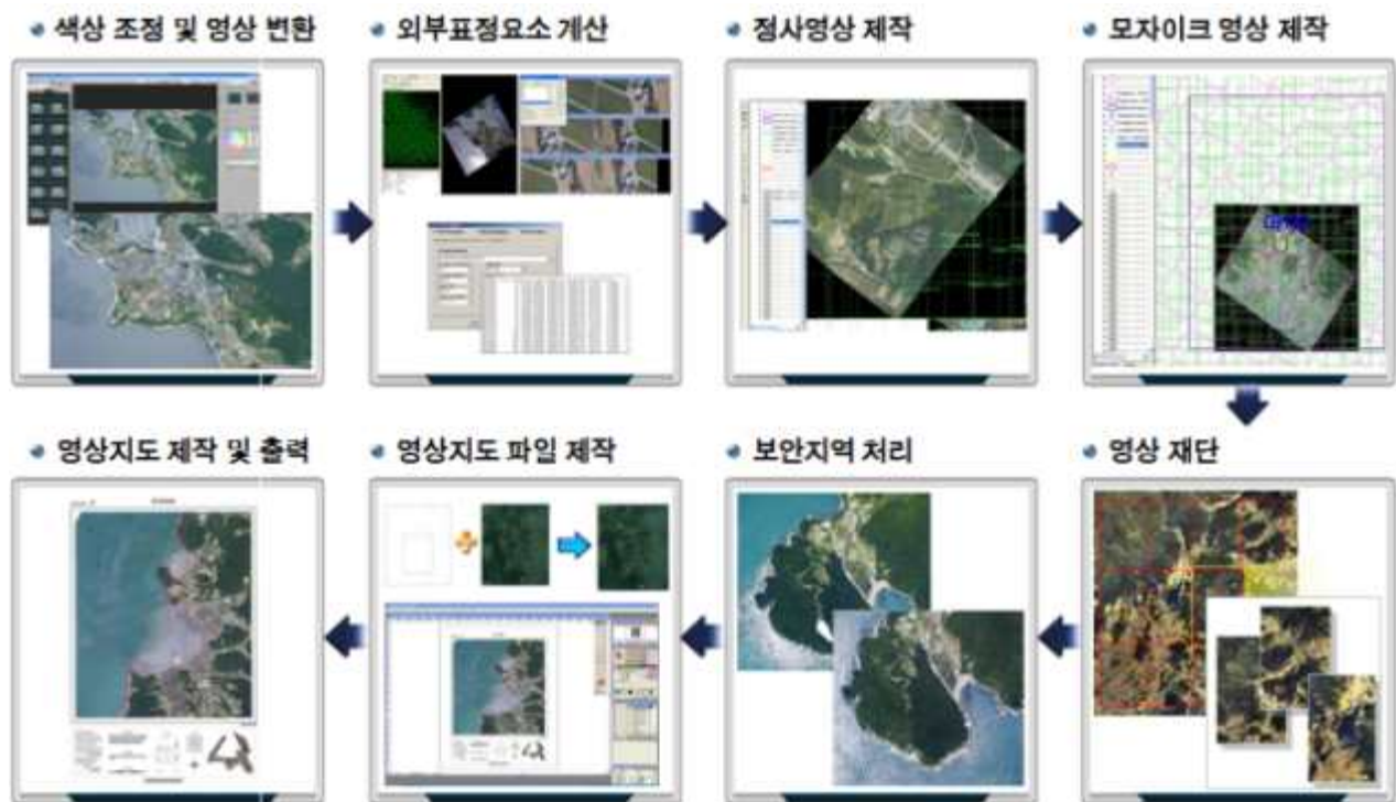
그림 2-3. 정사영상지도 제작 과정.
