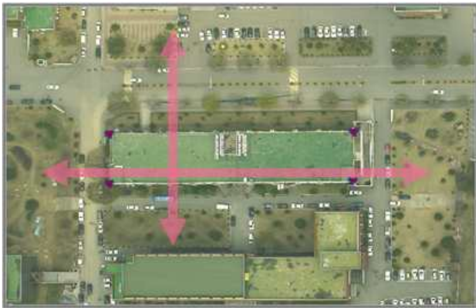
그림 3-11. Pitch 보정을 위한 비행방향.
