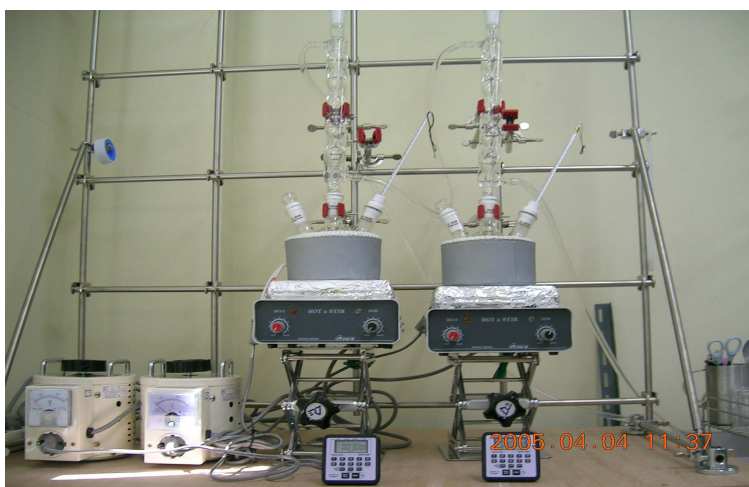
Figure 27. 카테킨 추출을 위한 실험 장치
