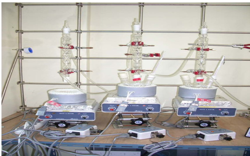
Figure 35. 카테킨 추출하기 위한 실험 장치
