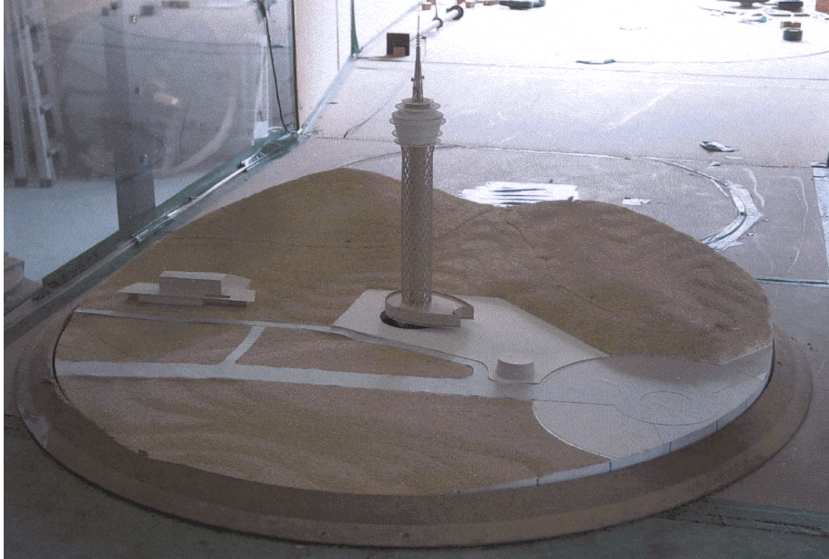
그림 4-26 풍동내에 설치된 풍력모형의 모습
